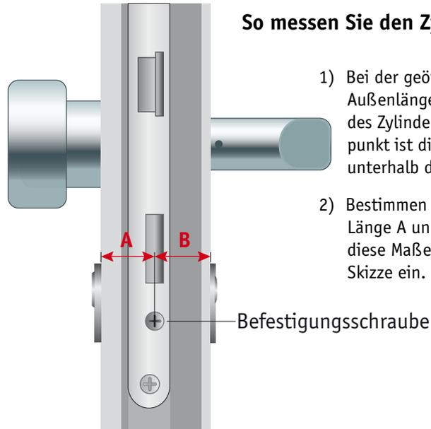
**Achtung:** Auf der Außenseite „A“ darf der Zylinder max. 3 mm über den Beschlag hinausstehen.
