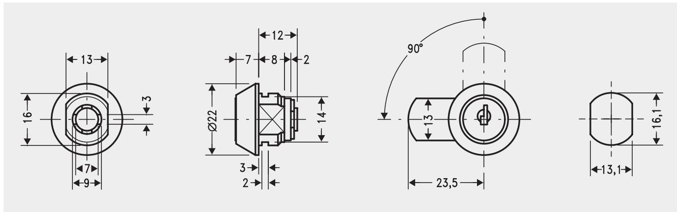
Zylinder: Zink-Druckguß, glanzverchromt.
