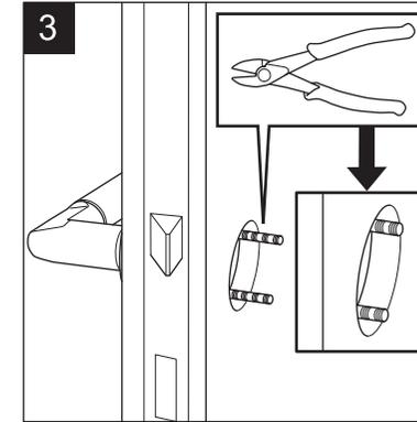
Halten Sie den inneren Türdrücker an das Türblatt. Stecken Sie die Befestigungsschrauben durch Rosette und Türblatt. Kürzen Sie die Schrauben an den Teilgewinden, die max. 6 mm am Türblatt überstehen. Für den Außendrücker ist eine Bohrung mit einem Durchmesser von 22 mm erforderlich.
