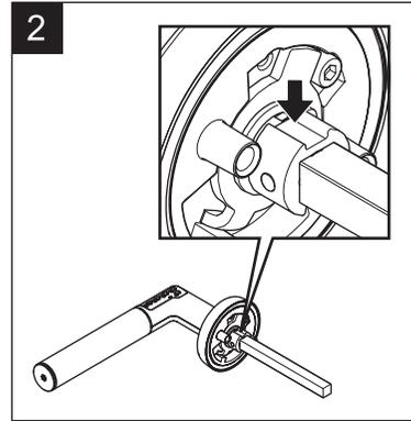
Drehen Sie den Vierkant so, dass die Nut nach oben zeigt (s. Abb. 2).
