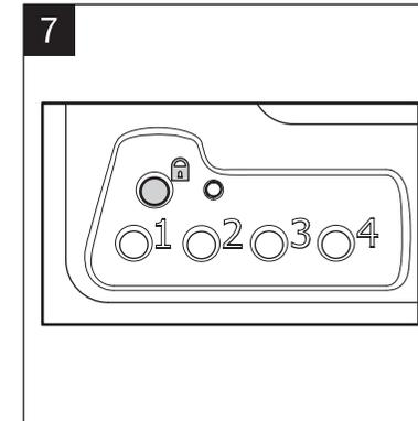
Drücken sie die Vorhängeschloss-Taste. Der Drücker wird gesperrt.
