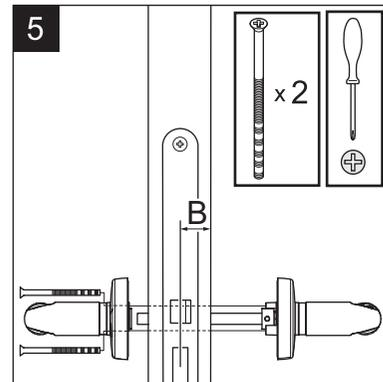
Verschrauben Sie den Innen- und Außendrücker miteinander. Ziehen Sie die Schrauben nur so fest an, dass die Drücker leichtgängig sind und in die Waagrechte zurückdrehen.
