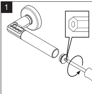
Öffnen Sie die Batteriekappe. Verwenden Sie dazu den Sicherheits-Bit (im Lieferumfang).
