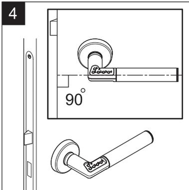
Bringen Sie den Außendrücker (mit Tastenfeld) an der Tür an. Halten sie den Drücker während der Montage in waagerechter Position.
