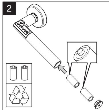
Drücken Sie den Drücker nach unten und entnehmen Sie die Batterien. Setzen Sie zwei neue Batterien Typ CR2 richtig ein (s. Abb. 2).
